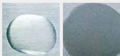
無処理板 りん酸マンガン皮膜処理板 油を一滴落としたときの拡がり方の比較
